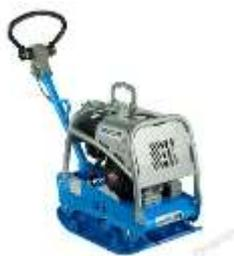
Виброплита с бензиновым двигателем Honda WEBER CR-3Hd имеет округлые края, идеально подходит уплотнения грунта в траншее, ГПС, гравия. Может использоваться для уплотнения песка, гравия, уплотнения брусчатки (со специальным полиуретановым ковриком), тротуарной плитки. CR-3 имеет реверс, с помощью которого не требуется разворачивать машину при обратном проходе
